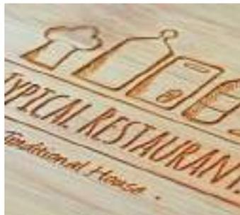
Utilização de um raio laser de grande precisão, permitindo uma gravação em baixo-relevo. Este laser pode ser de fibra ótica, adequado para metais, ou de CO2, adequado para madeiras ou cortiça.
